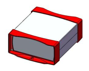
GB-T-819.1-2000-C-NI-M3X8 碳钢镀镍十字沉头螺丝M3X8 普通碳钢 0.0005 8 YG-K08B-0000-003 挡板 5052-H32 0.025 2 3 YG-K08B01-0000-002 K08B红色塑料防护框 ABS 2 0.021 YG-K08B-0000-001 壳体 6063-T5 2 0.119 序号 名称 材料 数量 单重 图号 备注 Tolerances
