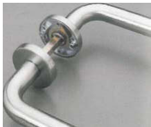
Rosette tonde con molla di ritorno per fissaggio contrapposto. Utilizzano serrature con fori ad interasse 38mm. Sottorosetta in lega metallica e coprirosetta in acciaio inox AISI 316L.
