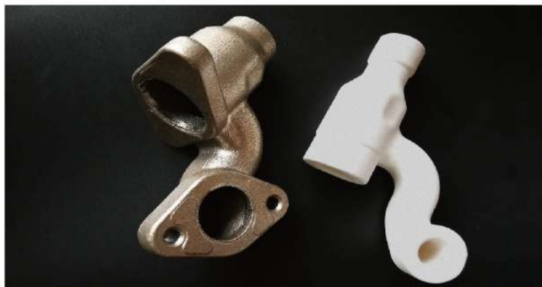
陶瓷型芯的使用情况 Use Of Ceramic Core
